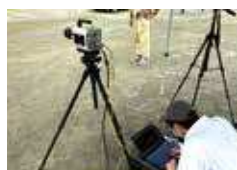
ハイスピードカメラによる速度計測
