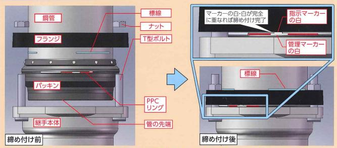
ミエルワは本体とフランジの間に設けられたパッキンの凹部に挿入されたPPCリングによって、ボルトを締め付けることで膨張するパッキンの外周長の変化を「見える化」することを可能にしたツールです。
