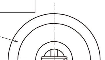
金具枠の上面は、仕上げ面より高くならないように施工して下さい。
