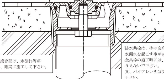
接続管との接合部は、水漏れ等がないように、確実に施工して下さい。
