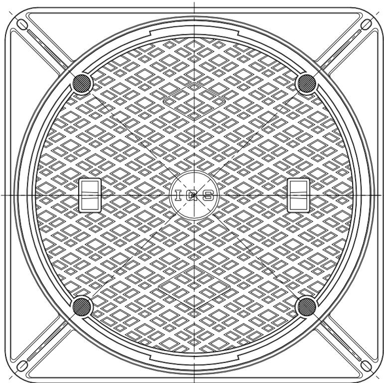
注1) キャップの取り付けは袋ナットを蓋面より1mm以上下げて仮締めしキャップをかぶせプラスチックハンマー等でたたき取り付けてください。1mm以下ですとキャップが働きません。
