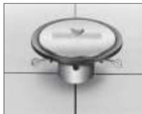
④ドレイン本体に養生蓋をかぶせ、プレート、ナットで固定します。生コンが流入しないようにして下さい。
