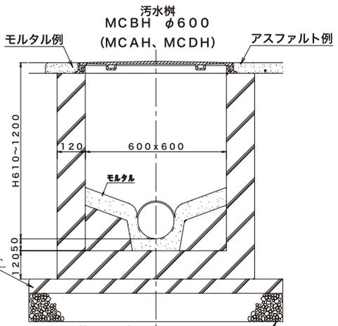
※マンホール枠の四つ角に切り込み碎石アンカー止め用の穴、φ13mmが開いています。(クラッシャーラン)
