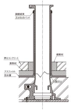
**3.** アンカー穴に鉄筋を通して スラブ配筋と結束してください。
